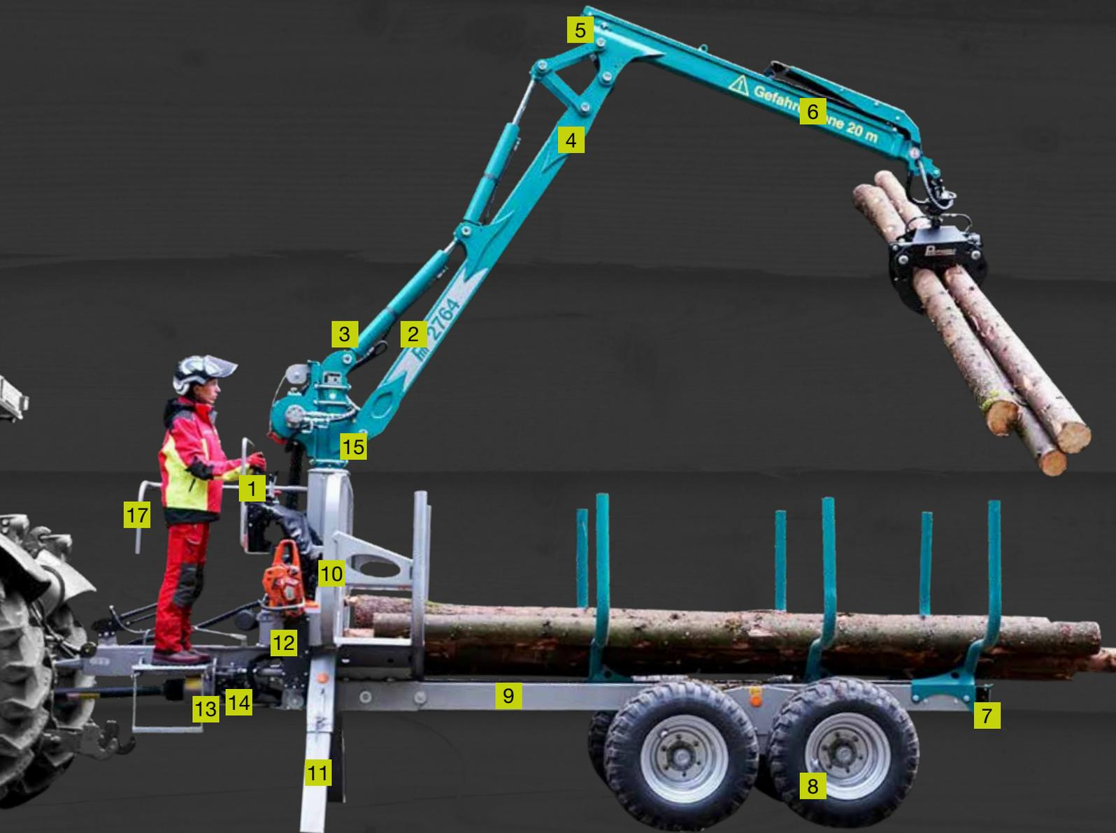
**1** **Commande ergonomique** avec commande à joystick.
