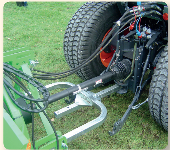
Timone idraulico da utilizzare con cardano omocinetico e/o spazzola idraulica per pulizia bordi stradali. (accessorio) Draw bar to use with wide angle pto shaf and/or with hydraulic brush for side roads cleanning. (accessory) Timon hydraulique pour emploi avec cardan grand angle et ou balai hydraulique pour le nettoyage des bords de route (accessoire) Zugdeichsel zur Verwendung mit Weitwinkel-Gelenkwelle und / oder hydraulischer Seitenbürste zum Straßenränder-Auskehren (optional).
