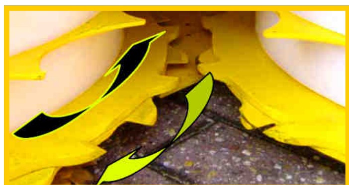
Système de coupe type « sécateur » : Coupe nette qui respecte la végétation
