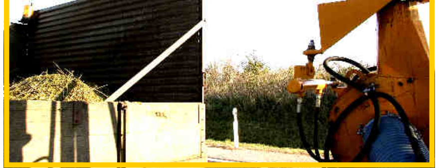
Soufflerie de chargement auto-alignante. Chargement d'une remorque, d'un camion benne tracté,...
